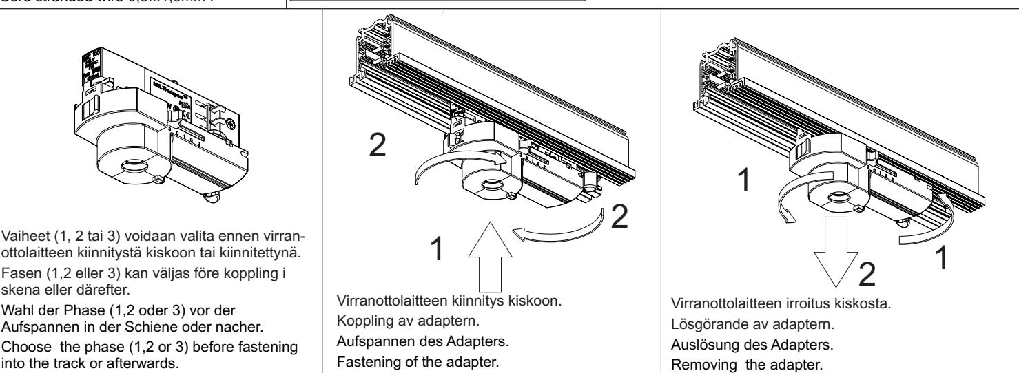
Vaiheet (1, 2 tai 3) voidaan valita ennen virranottolaiteen kiinnitystä kiskoon tai kiinnitetynä.
