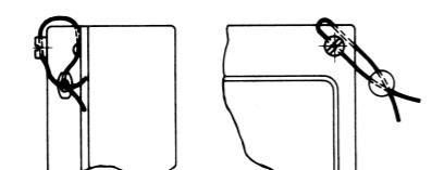
1. Rechte obere Deckelschraube ersetzen durch beigelegte Plombierschraube (mit Querloch)
