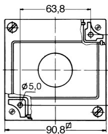
Cet appareil ne doit pas être installé à l'ombre d'arbres ou d'arbustes. Sinon l'interrupteur crépusculaire s'éteint trop tard le matin. Les trous de fixation (Ø 5 mm) sont accessibles en levant le couvercle (4 vis).
