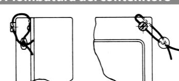
1. Sostituire la vite superiore destra del coperchio con l'apposita vite da piombatura fornita in dotazione (con foro trasversale).
