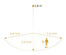
Mögliche Montagehöhe: 1,80 m – 2,00 m Orange: radial und tangential 3 skalierbare Achsen
