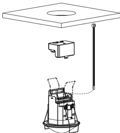
Montaggio in solai cavi per spessori del soffitto da 0,5 mm a 3 cm. Il diametro della sezione del soffitto deve essere compreso tra 62 mm e 70 mm. Lo
