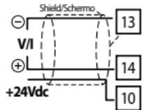
**Per segnali normalizzati in corrente e tensione.**
