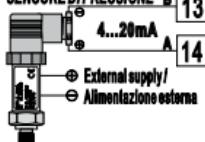
Per segnali normalizzati in corrente 0/4..20 mA **con sensore ad alimentazione esterna.**
