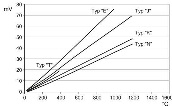
Figure 8-1 Thermocouples J, K, T, E, N
