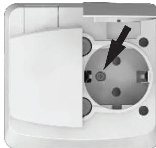
2. Lossa de två skruvarna under uttagslocken på uttaget och ta av uttagets överdel. Koppla in uttaget enligt den installationsanvisning som följer med uttaget.
