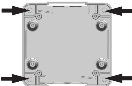
1. Skruva fast montageramen i underlaget med skruvar genom montageramens fyra hörn.
