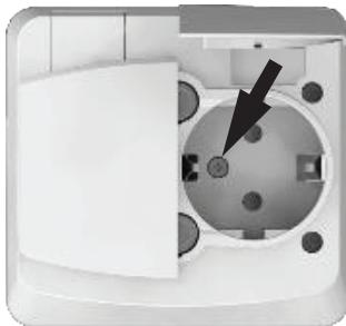
4. Sätt tillbaka uttagets överdel på uttagsinsatsen och skruva fast den med de två skruvarna som finns under uttagslocken. Obs! den gummitätning som följer med uttaget skall inte användas vid installation med montageram.
