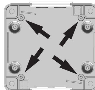
3. Skruva fast uttagsinsatsen i montageramen med de fyra medföljande skruvarna.
