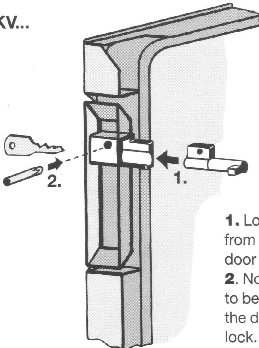
**1.** Tür öffnen, Schloß ohne Schlüssel von hinten in das Griffstück der Türverriegelung einschieben.
