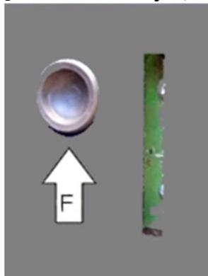
*Kabelskydds-brytaren ligger innanför locket, under en skyddspropp [F]*
