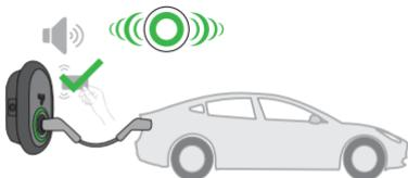
**4-** Voit aloittaa latauksen aiemmin valtuutetulla kortilla, jos latausasema on RFID paikallisen luettelon valtuutustilassa. Jos latausasema on hyväksy KAIKKI RFID:t tilassa, voidaan lataus aloittaa millä tahansa tuetulla RFID-kortilla.
