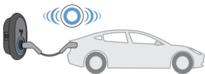
**5 - Lataus käynnistyy ja LED-tilavalto hehkuu sinisenä.**
