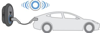
**5 -** Lataus käynnistyy ja LED-tilavalto hehkuu sinisenä.
