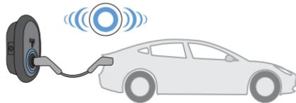
**5 -** Lataus käynnistyy ja LED-tilavalto hehkuu sinisenä.
