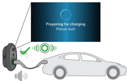
**5 - Lataus käynnistyy ja LED-tilavalto hehkuu sinisenä.**
