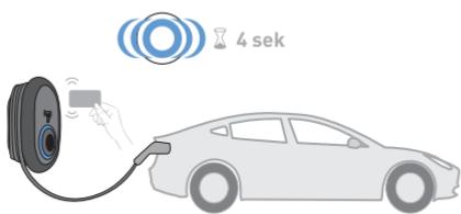
**3-** Tryck RFID-användarkortet mot RFID-läsaren.
