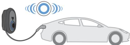
**3-** Tryck RFID-kortet mot RFID-läsaren. Laddningen kan börjas med kortet som tillhandahållits av din laddningsoperatör.
