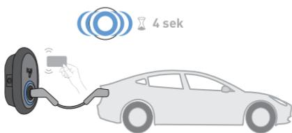
**3-** Tryck RFID-användarkortet mot RFID-läsaren.
