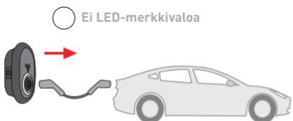
**Menetelmä 3.** Voit lopettaa latauksen irrottamalla latauskaapelin ajoneuvosta.
