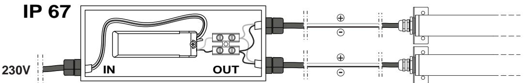
**Montaggio dell'alimentatore: remoto - Converter mounting: remote
