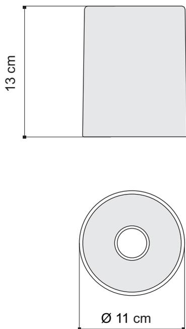
Dimensioni per il fissaggio a plafone
