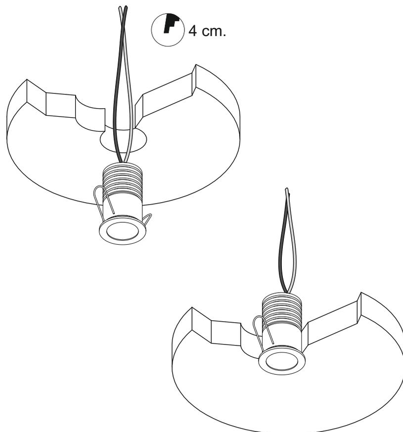
**Montaggio dell'alimentatore: remoto - Converter mounting: remote -
