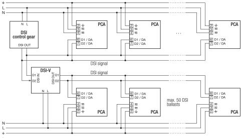
$<sup>^{</sup>ullet}$  One DSI-V/T corresponds to the DSI load of two DSI devices.
