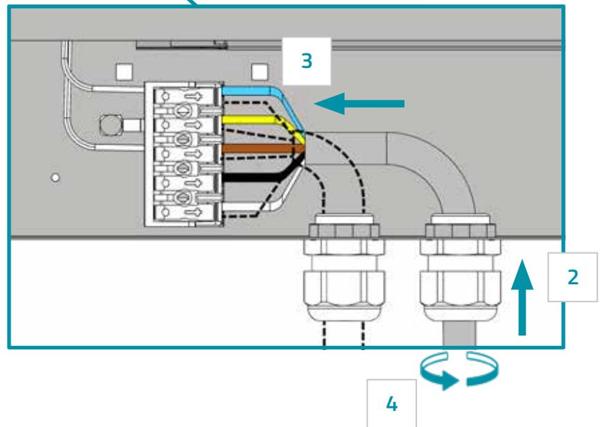
Liitäntä on suoritettava kohteen suojausluokituksen mukaisesti käyttäen tarvittaessa suojausluokituksen mukaista jakorasiasia. Liitäntälaitetekotelon/Valaisimen ollessa varustettu kiinteällä syöttökaapelilla, ei kaapelia saa vaihtaa, eikä valaisinta avata.
