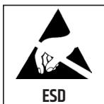
Valonlähteen saa vaihtaa ainoastaan valmistaja tai valmistajan valtuuttama henkilö. Tuote sisältää sähköstaattisille purkauksille (ESD) ja mekaaniselle rasitukselle herkkää elektronikkaa. Vahinkojen välttämiseksi, vältä koskemasta avointa piirilevyä, kuten esim. LED-moduulia käsin tai työkalulla. Tämä tulee huomioida huollon aikana.
