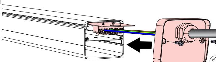
Tightening torque 0,3 Nm
