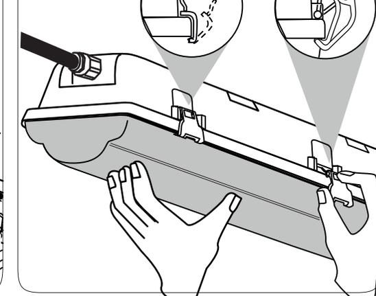
Bei Wandmontage muss die Leitungseinführung unten positioniert sein
