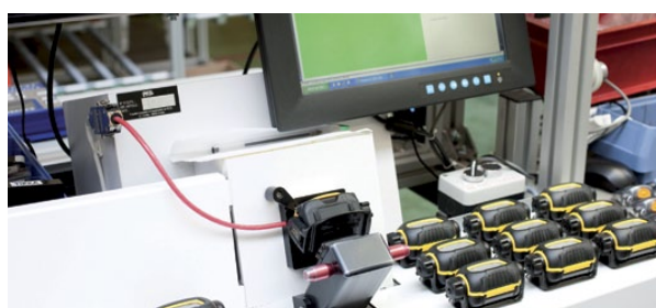
Yksilökohtainen valaisimen suorituskykytesti
