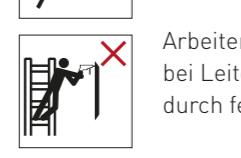
Arbeiten vermeiden, die eine seitliche Belastung bei Leitern bewirken, z.B. seitliches Bohren durch feste Werkstoffe.
