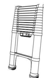
Pour déployer l'échelle, assurer sa stabilité en posant un pied sur le barreau inférieur et tirer vers le haut sur les deux montants supérieurs. Déployer l'échelle complètement.
