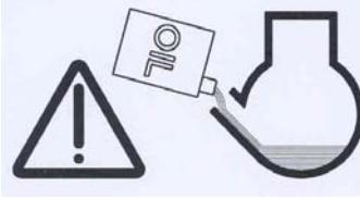
Varning: Generatoraggregaten levereras utan olja.
