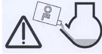
Pas på: at generatoraggregatet er leveret uden olie.
