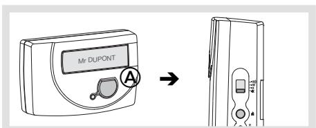
! Si aucun appui n'est effectué sur le bouton de configuration **(A)** de l'émetteur 2 minutes après avoir appuyé sur le bouton de configuration **(3)** du récepteur, celui-ci retourne en mode normal.
