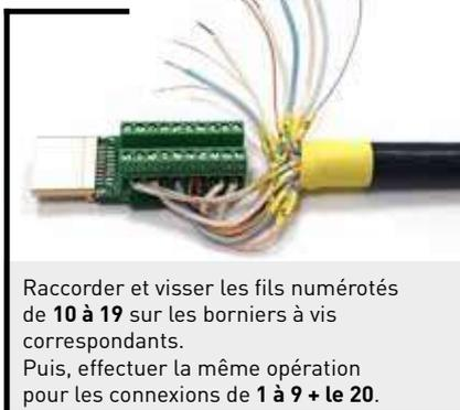
Raccorder et visser les fils numérotés de 10 à 19 sur les borniers à vis correspondants.
