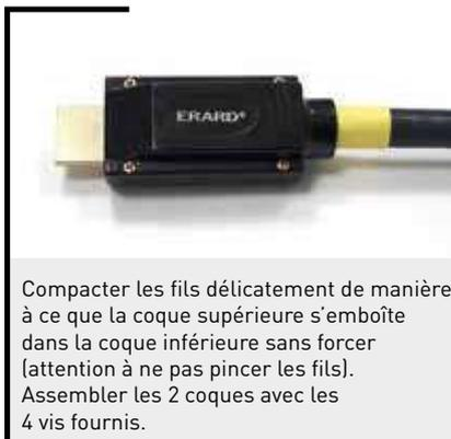
Compacter les fils délicatement de manière à ce que la coque supérieure s'emboîte dans la coque inférieure sans forcer (attention à ne pas pincer les fils).
