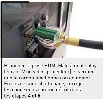
Brancher la prise HDMI Mâle à un display (écran TV ou vidéo-projecteur) et vérifier que le cordon fonctionne correctement.
