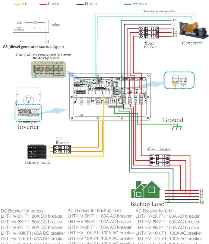
LHT-HV-15K F1: 80A DC breaker LHT-HV-15K F1: 100A AC breaker LHT-HV-15K F1: 100A AC breaker LHT-HV-20K F1: 80A DC breaker LHT-HV-20K F1: 100A AC breaker LHT-HV-25K F1: 100A AC breaker LH
