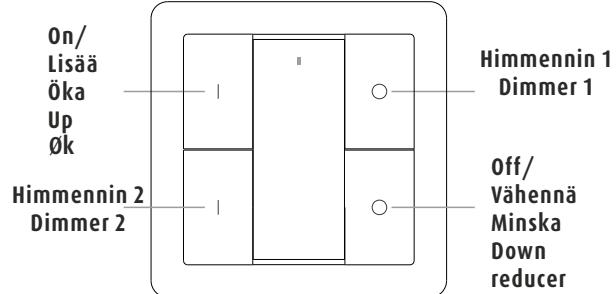
Kaukosäätimessä on kaksi eri kanavaa, joilla voidaan ohjata (ON / OFF + himmennys) erikseen kahta eri himmennintä (640350). molemmat käyttöönottettavat kanavat on parittavaa erikseen himmentimen kanssa. Säädin sopii käytettäväksi oman kehysensä lisäksi alla mainittujen sähkökalusteidenv kanssa.
